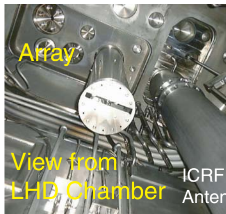
図 5.7 LHD 内部より撮影した軟 X 線検出器。中央の円筒上のものが図 5.6 の (b) を下から撮影したものである。
